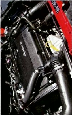
Opel: 1,6-Liter-Turbo, stärkster Motor im Test, Verbrauch: 9,4 l/100 km
