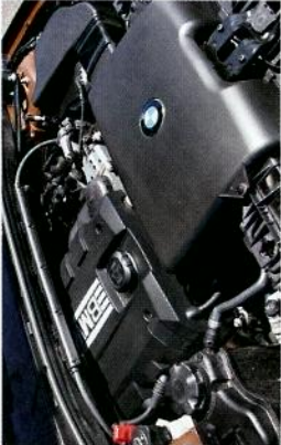
BMW: 2,0-Liter-Sauger, weit hinten eingebaut, Verbrauch: 7,7 l/100 km
